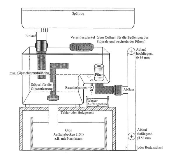
Masse Gipsabscheider: Breite 380 mm, Höhe 380 mm, Tiefe 300 mm Gewicht ca. 5,3 kg
